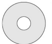
86827 Washer 6x19x0.2mm Scheibe 6x19x0.2mm Rondelle 6x19x0.2mm ワッシャー 6x19x0.2mm
